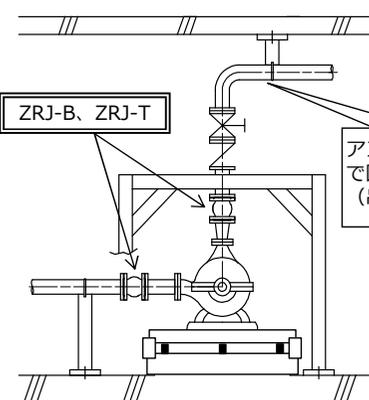
ポンプ廻りの吐出側については、レジャーサ、製品、逆止弁、仕切弁の順に取り付けて下さい。
